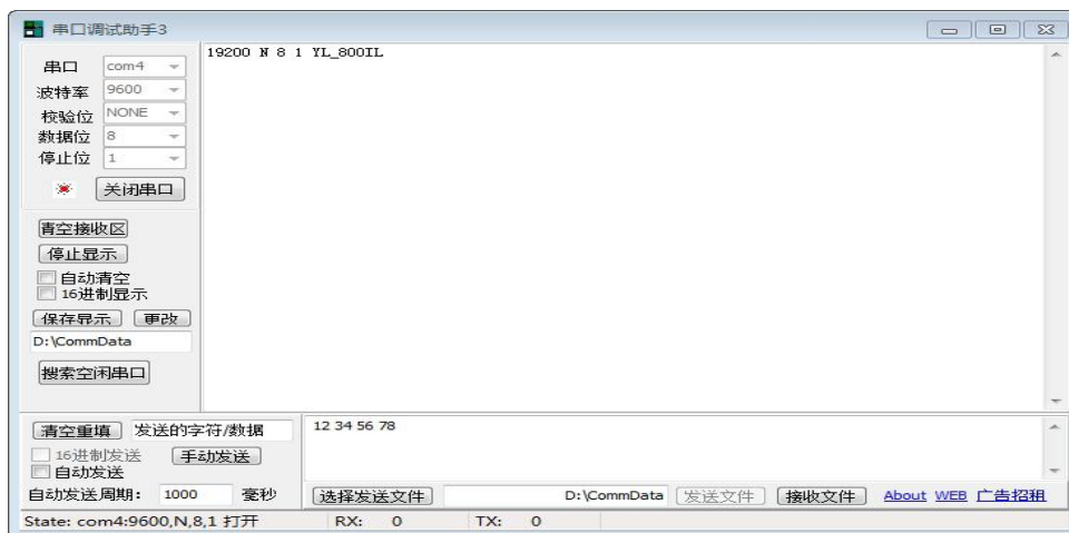
图 8.3.1 用串口调试助手获取模块当前串口参数
