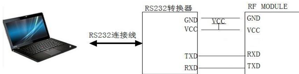
图 8.1 无线模块和电脑连接示意图（TTL）
