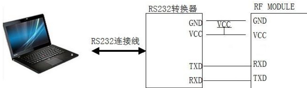
图 9.1 无线模块和电脑连接示意图 (TTL)
