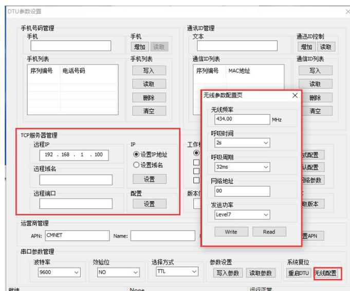
界面左侧“TCP 服务器管理”用于设置与网关连接的服务器的 IP 地址、域名和端口号。
