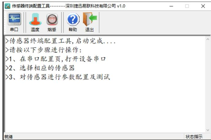
把传感器通过 USB-TTL 数据线 (mini-USB 接头) 接上电脑后，此时传感器处于设置状态，打开“传感器终端配置工具”，点击“串口”，弹出“串口配置页”，选择传感器连接电脑的 COM 端口，用波特率 9600，效验 NO 打开。
