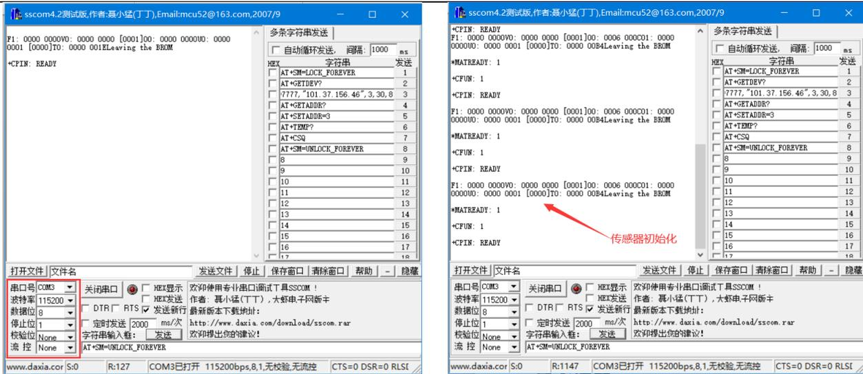
然后磁铁吸合 USB 接口旁边的磁开关，这时传感器的红灯会常亮，串口调试助手接收框会显示初始化的信息，然后即可读写相关参数。如上右图：
