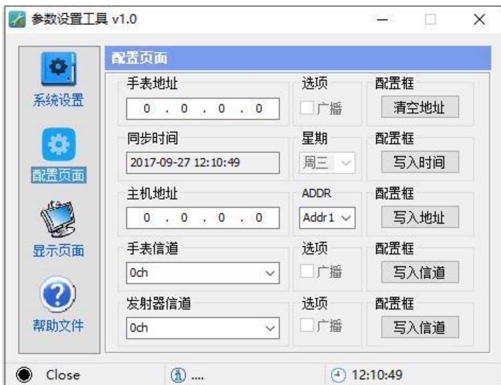
**手表地址：**指手表自带固定的“本机地址”，可在手表上“查看无线参数”菜单栏查看。填写指定的手表地址，就可以给指定的手表设置参数。
