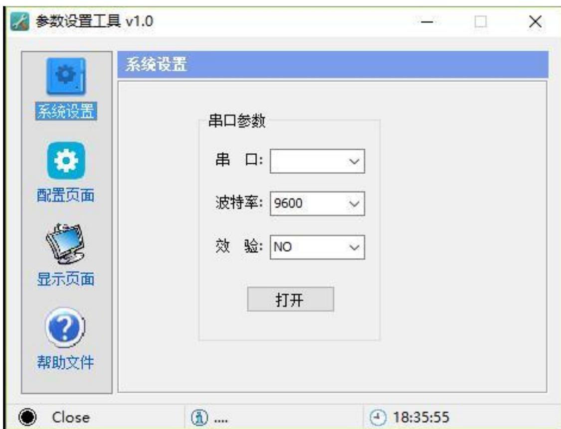
把发射模块连接到电脑后会得到一个端口，打开测试工具选择相应端口号，选择发射模块所配置的波特率和校验方式，打开这个端口。发射模块出厂默认的串口参数是波特率 9600 无校验（NO）。
