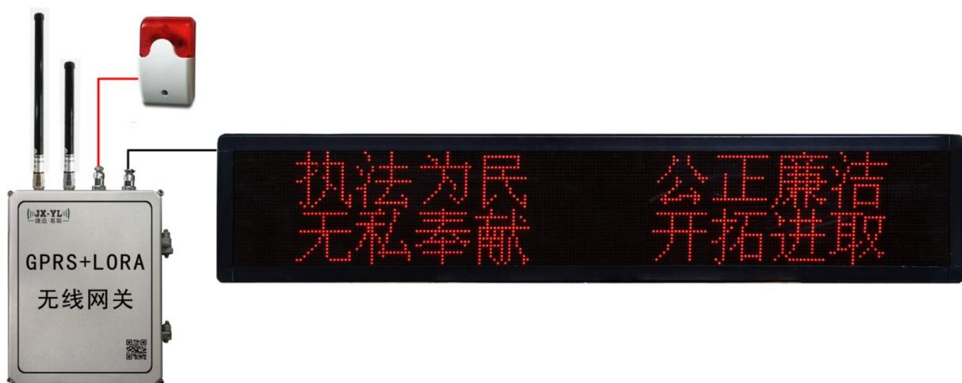
无线网关作为报警系统的信息枢纽，内部包含 GPRS 通讯模组、LoRa 通讯模组、ARM 处理器、220V 电源管理，外部可接 LED 显示屏、声光报警器。
