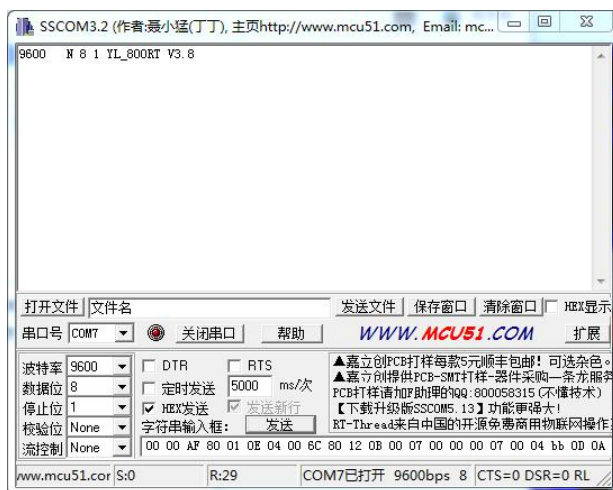
图 9.3.1 串口调试助手获取模块当前串口参数和软件版本号
