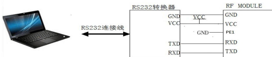
图 9.1 无线模块和电脑连接示意图 (TTL)
