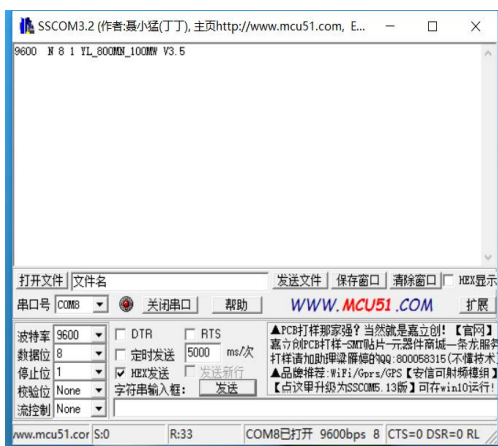
图 9.2.1 串口调试助手获取模块当前串口参数和软件版本号
