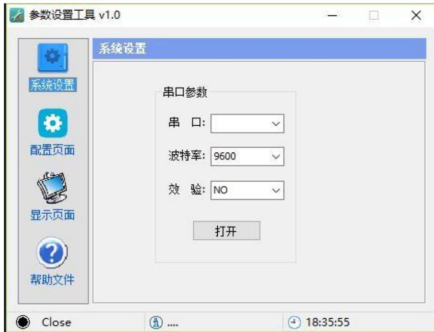
把发射器连接到电脑后会得到一个端口，打开测试工具选择相应端口，以默认波特率 9600 无校验打开端口。
